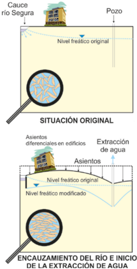
figura x - Esquema conceptual del origen de la subsidencia del terreno.
